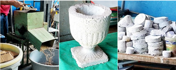
Figura 4 – Máquina de triturar papel, papelão e isopor para fazer vasos, carvão branco e outros fins
