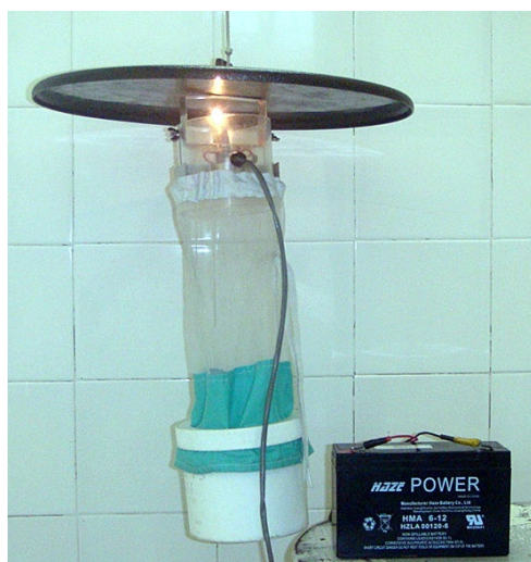
Figura 5: Armadilha luminosa tipo CDC. Foto- Lindemberg Caranha
